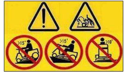
**▲ DANGER!** **REDUCE SPEED BEFORE ANY CHANGE OF DIRECTION ON SLOPES**
